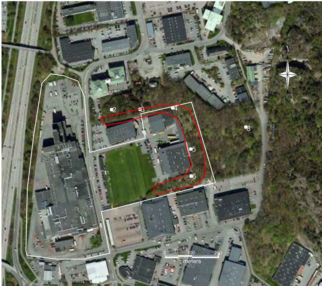
Figur 1 Flygbild över det undersökta området, med mätpunkter för radon och strukturmätningar angivna. Röd markering visar områden där det finns risk för blocknedfall på grund av höga skärningar och ogynnsamma strukturriktningar
